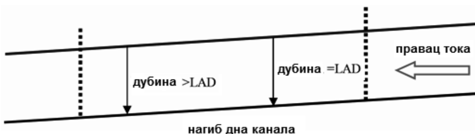
Слика 32. Ситуација са максималним протоком кроз Канал (спуштене уставе)
