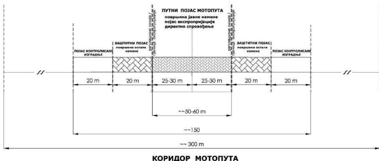
Слика 7: Шематски приказ попречног профила коридора мотопута
