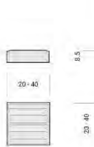
в. Камено тактилно поље безбедности/упозорења Тип 2
