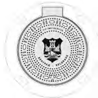
б. Канализациони шахт поклопац
