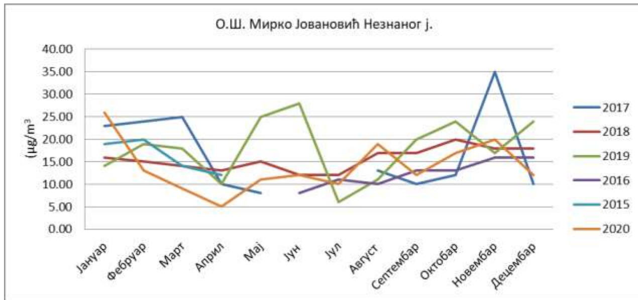
Слика 24. Средње месечне концентрације азот диоксида у \mu\text{g}/\text{m}^3 на мерном месту ОШ „Мирко Јовановић“
