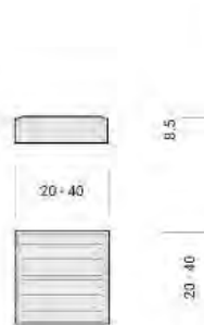
в. Камено тактилно поље безбедности/упозорења Тип 2
