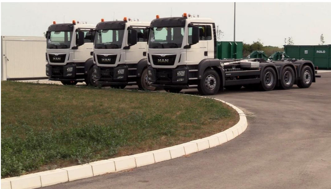
Slika 5: Vozila za prevoz rolo kontejnera
