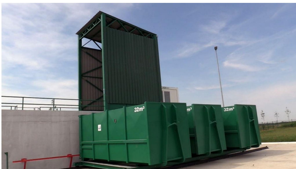
Slika 4: Usipni koš i rolo kontejneri na transfer stanici
