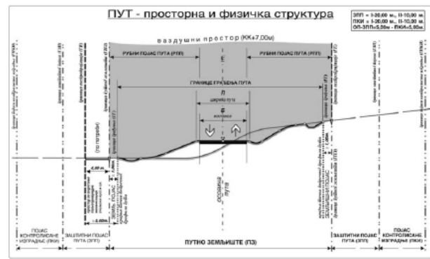
Слика 9: Просторна и физичка структура пута
