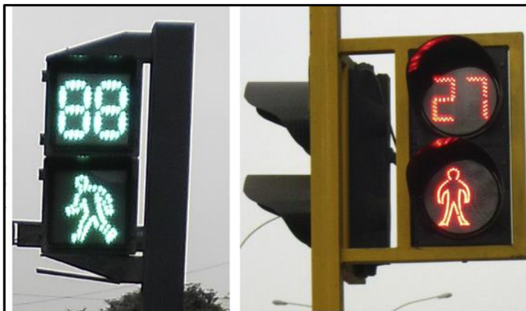
Слика 6-3 Изглед семафора са уређајем за одбројавање времена
