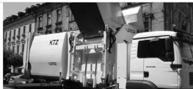
Слике бр. 4-7: Примери специјализованих возила за прикупљање и транспорт отпада из подземних контејнера
