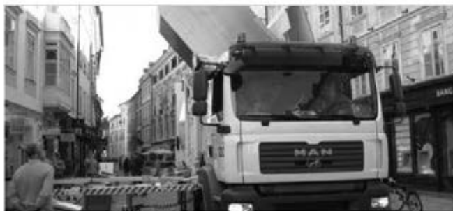
Слике бр. 4-7: Примери специјализованих возила за прикупљање и транспорт отпада из подземних контејнера
