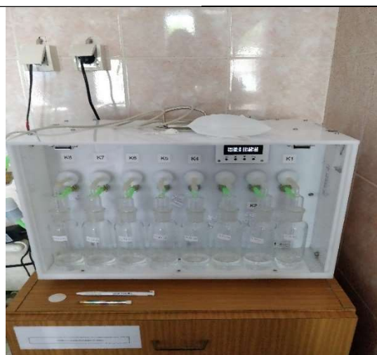
Слика 12. Дволинијски узоркивач ваздуха (фотографија достављена од стране Завода за јавно здравље Сомбор)
