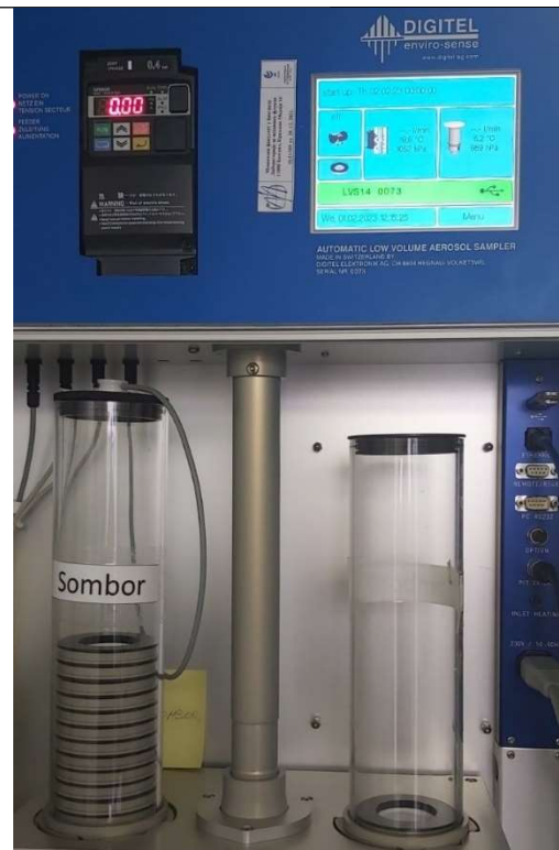
Слика 6. Детаља- приказ аутоматске мерне станице, узоркивач суспендованих честица*
