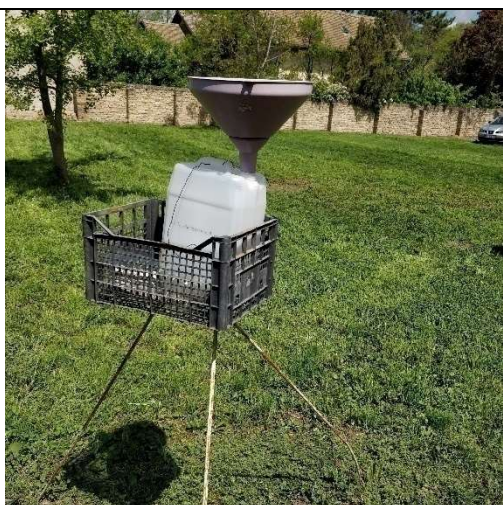
Слика 11. Седиментатор за таложне материје (фотографија достављена од стране Завода за јавно здравље Сомбор)
