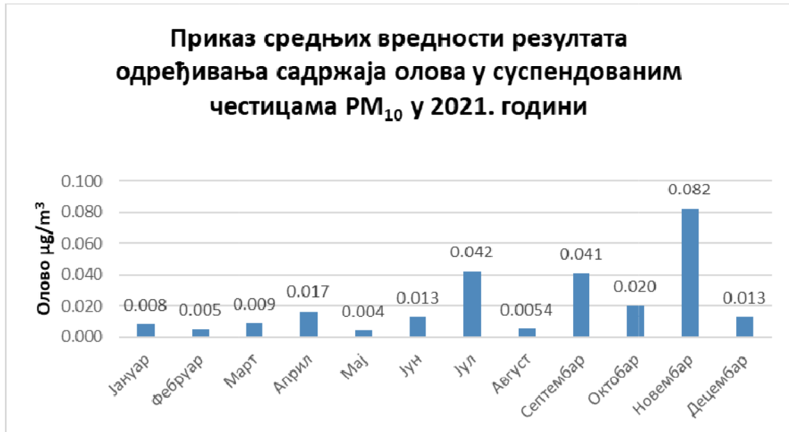
График 10. Приказ средњих вредности резултата одређивања садржаја олова у суспендованим честицама PM_{10} у 2021. години
