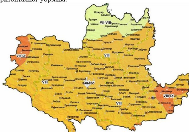
Слика 4: Карта сеизмичког hazarda на површини локалног тла за Колубарски округ.
