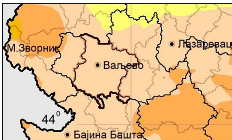
Слика 6: Карта сеизмичког хазарда за повратни период од 475 година; прогнозирани интензитет је 8. степен EMS-98 (Републички сеизмолошки завод).
