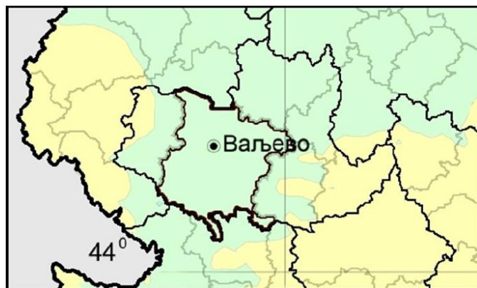
Слика 5: Карта сеизмичког hazarda за повратни период од 95 година; прогнозирани интензитет је 6. степен EMC-98 (Републички сеизмолешки завод).
