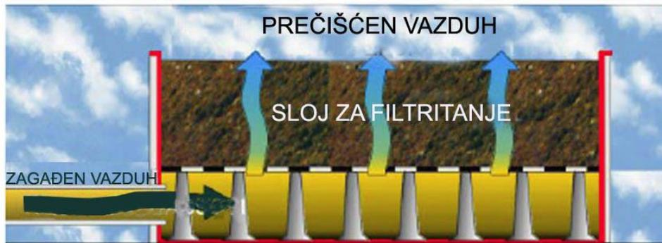
Princip rada biofiltra
